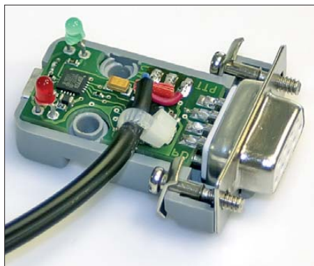
Bild 6: PTT- und Key-Leitungen mit Zugentlastung durch einen Kabelbinder (wird nach Aufsetzen des Deckels wirksam)
