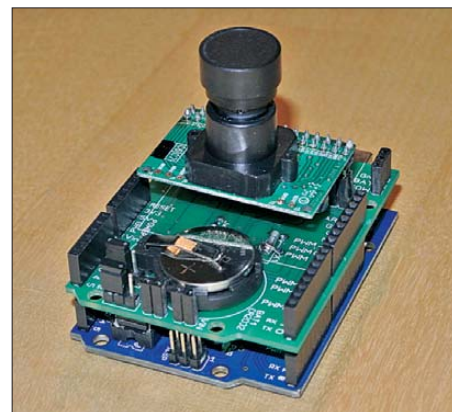
Bild 3: Das selbst gebaute Shield lässt sich auf beliebige Arduino- Boards, hier auf ein Arduino Duemilanove , aufstecken. Fotos, Screenshot: OE1RIB
