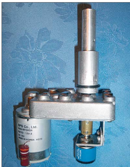
Bild 6: Getriebemotor mit angesetztem Aluminiumreduzierstück und Potenziometer
