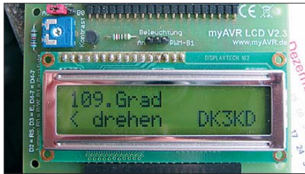
Bild 5: Auf dem Display werden die eingestellte Antennenposition und die bei Änderungen ermittelte Drehrichtung angezeigt.
