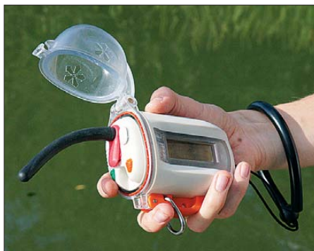
Die Sprechasten sind etwas klein geraten. Das Display zeigt den aktuellen Längen- und Breitengrad, den Ladezustand des Akkumulators sowie den eingestellten Seefunkkanal. Das Funkgerät ist auch mit offener Abdeckung wasserdicht. Fotos: Hub
