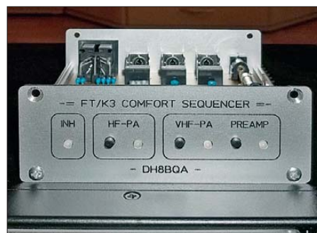
Bild 8: Frontplatte des Sequenzer-Gehäuses; die Bedien- und Anzeigeelemente sind logisch zusammengehörig gruppiert.
