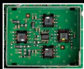
HF Verstärker mit dem großzügig dimensionierten Breitbandüberträger
