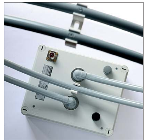
Bild 2: Der Rahmen mit seinen beiden Windungen fuÙt in einem Kunststoffgehäuse mit 50-Ω-Antennenbuchse und zwei Drehkondensatoren zur Abstimmung.
