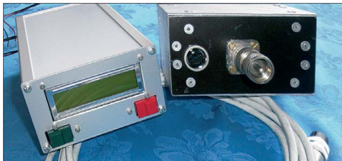
Bild 1: Steuereinheit, Motorgehäuse und Steuerkabel; die Displayplatine wurde hinter der Front der Steuereinheit befestigt. Die Taster sitzen auf einer kleinen separaten Platine darunter.
