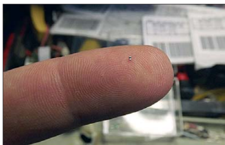
Bild 2: Der Hinweis „Vor dem Fotografieren Hände waschen!“ wäre hier fehl am Platze – das Schwarze auf dem Finger von DC2PD ist ein SMD-Widerstand der Größe 0402!
