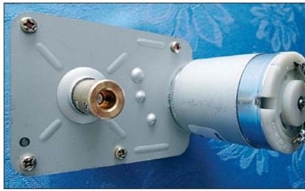
Bild 4: Motor und Achskupplung 4/6 mm zum Befestigen des Potenziometers
