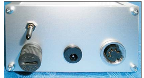
Bild 8: Auf der Rückfront der Steuereinheit befinden sich Beleuchtungsschalter, Sicherung, Spannungs- und Anschlussbuchse.
