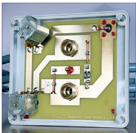
Bild 3: Die Bauteile (links die beiden Drehkondensatoren) der Magnetantenne sind für QRP-Leistung bis 10 W dimensioniert.
