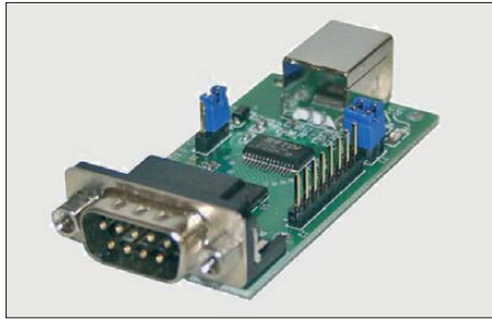
Bild 2: Das EVAL232R ist eines der Entwicklungsmodule von FTDI, die für USB-Interfaces gut geeignet sind.
