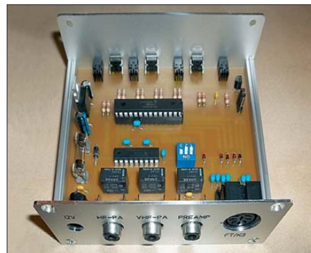
Bild 9: Blick in das geöffnete Gehäuse; an der Rückseite kommen nur Standardbuchsen zum Einsatz.
